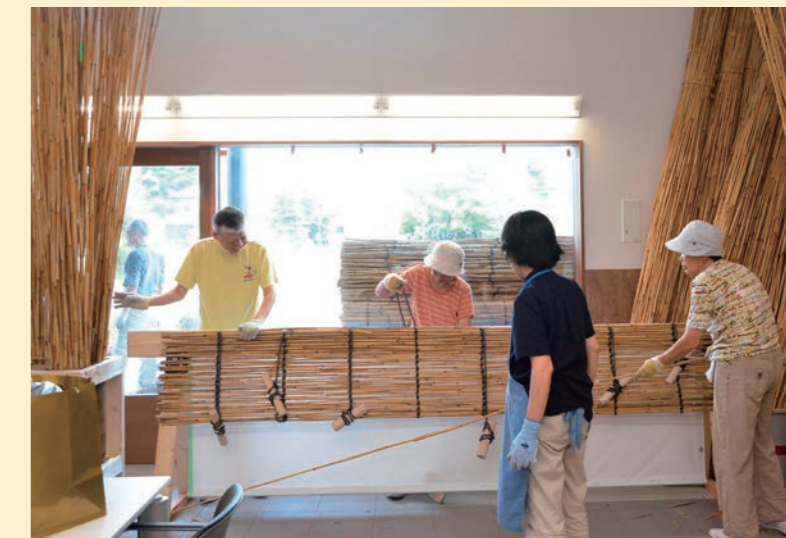
↑作業風景 葦は近江八幡市で仕入れ、皮をむいて長さを調整。手作りの編み機に1本ずつ重ね、2本のロープを交差させて縛り上げていく。縦約3メートル、横約1.2メートル。
